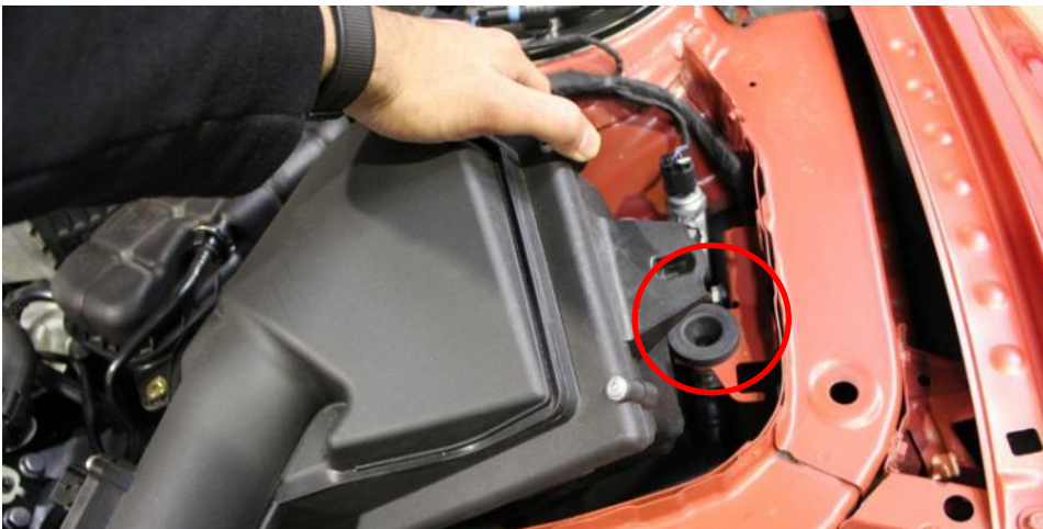
15. Ziehen Sie die rechte Seite der Airbox nach oben aus der Gummidichtung wie hier zu sehen. Entfernen Sie die Airbox und Rohranordnung vollständig aus dem Motorraum.
