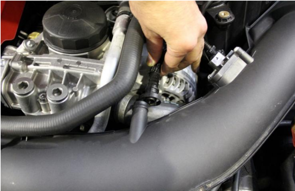
13. Entfernen Sie den Entlüftungsschlauch aus dem Rohr.
