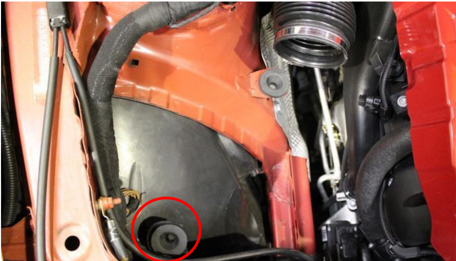
7. Die vordere Muffe sitzt auf einer dünnen Metallplatte, die nach oben mit der Airbox rausrutschen kann - wenn ja, setzen Sie diese wieder ein.
