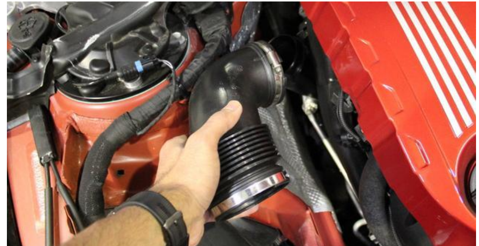
8. Lösen Sie die restlichen Schlauchschelle am Ansaugrohr und entfernen Sie aus dem Motorraum .
