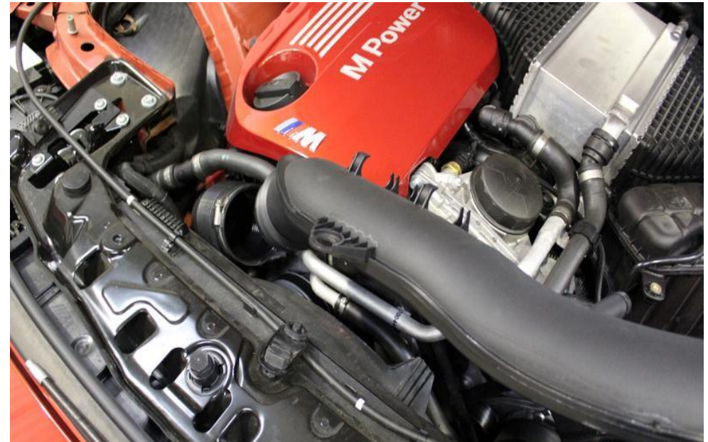
14. Die Schlauchschelle lösen und das Ansaugrohr aus dem Schlauch ziehen.
