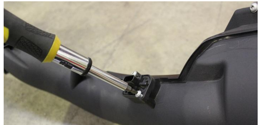
16. Mit einem Torx T20 - MAF-Sensoren links und rechts entfernen. Dieser Sensor ist äußerst sensibel!
