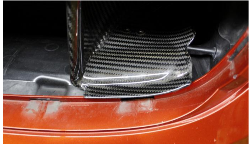
57. Ziehen Sie an der Stoßstange damit der Einlass Platz unter der Stoßstange findet.
