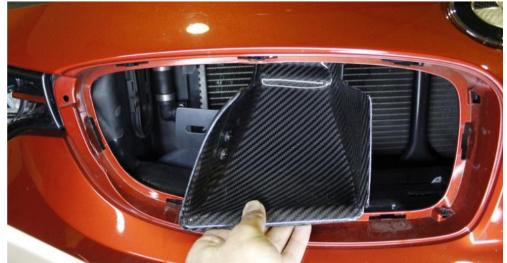
51. Führen Sie den linken Einlass wie auf dem Foto gezeigt ein, sobald eingeführt um 90° gegen den Uhrzeigersinn drehen.
