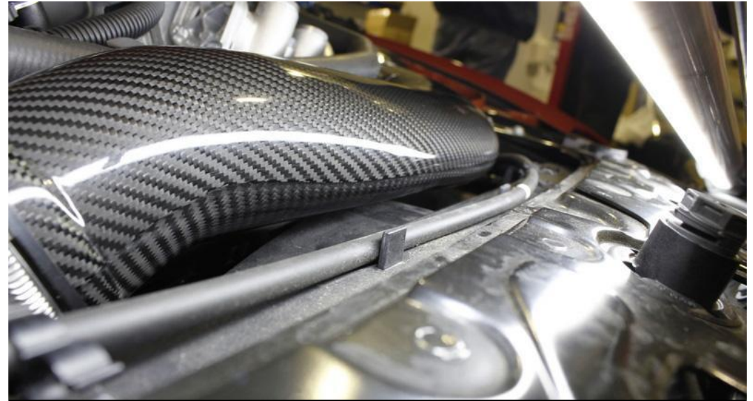
44. Drehen Sie das Rohr einen Spalt über die Lüftung um Kontakt zu vermeiden.
