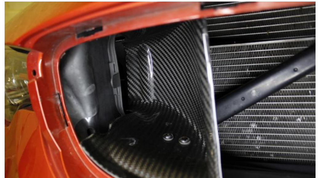
53. Die hintere Seite des Einlass sollte wie dargestellt in der Öffnung sitzen.
