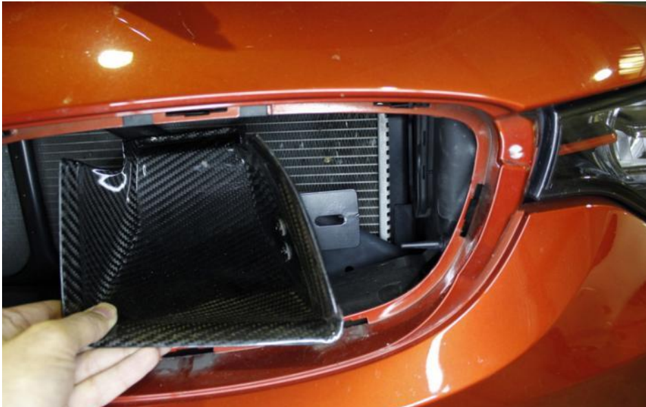
56. Führen Sie den rechten Einlass wie auf dem Foto gezeigt ein und drehen in um 90°.
