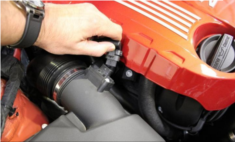
5. trennen Sie MAF-Sensor-Stecker von der linken Seite Airbox.
