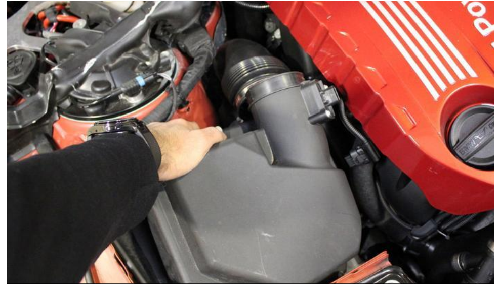
6. Schieben Sie das Ansaugrohr aus dem Luftfilterkasten und ziehen Sie dann die Rückseite der Airbox nach oben. Es wird von 2 Gummimuffen gehalten. Entfernen Sie die Airbox aus dem Motorraum .
