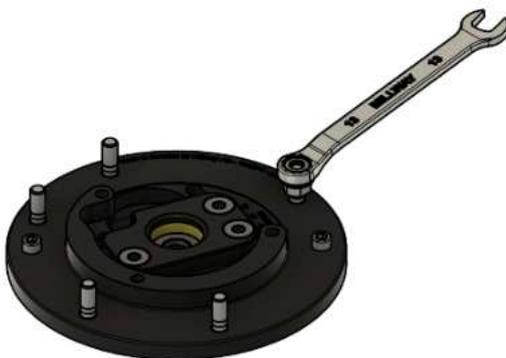
Nun können die Stehbolzen mit einem Anzugsmoment von 4 Nm von oben, wie in nebenstehender Abbildung, an den vorher ermittelten Positionen montiert werden. Anschließend sind die beiden Muttern wieder zu lösen und vom Stehbolzen herunterzudrehen. Es gilt darauf zu achten, dass sich der Stehbolzen hierbei nicht wieder aus der Trägerplatte des Domlagers löst!
