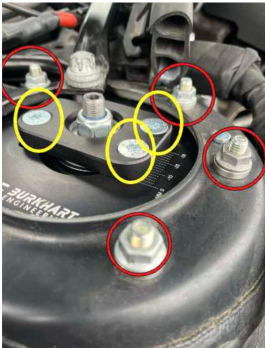
9. Wie in nebenstehender Abbildung rot markiert, müssen nun die Distanzscheiben und die Muttern montiert werden. Das Anzugsmoment der Muttern liegt bei 24 Nm.
