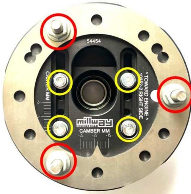
Las tuercas marcadas en rojo se utilizan para atornillar el rodamiento a la cúpula del vehículo (par de apriete: 25 Nm) y deben aflojarse para ajustar la inclinación y poder mover el rodamiento transversalmente.
