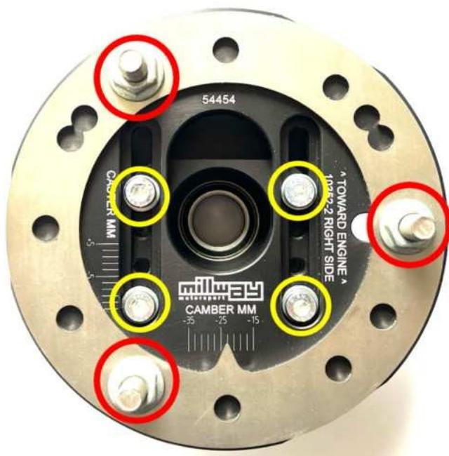
I dadi contrassegnati in rosso servono per avvitare il cuscinetto alla calotta del veicolo (coppia di serraggio: 25 Nm) e devono essere allentati per regolare la campanatura in modo da poter spostare il cuscinetto trasversalmente.
