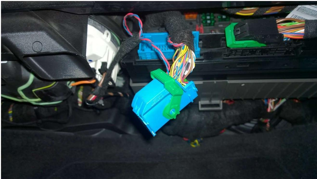
An dem Stecker nimmt man dann das Steckergehäuse ab (die Arretierung mit einem kleinen Schraubendreher oder mit dem Fingernagel zur Seite druecken und abziehen).
