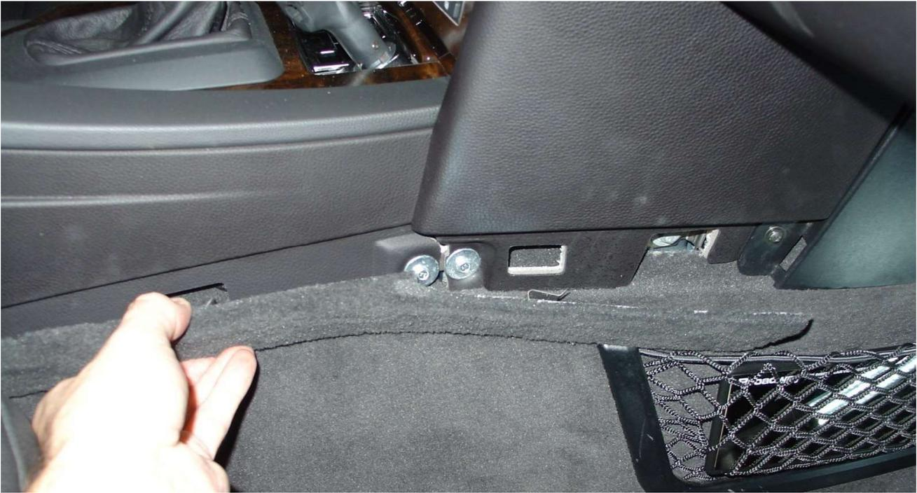
Dann die Schrauben entfernen und die Verkleidung abnehmen:
