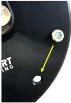
Al realizar el montaje en vehículos MINI, puede ser necesario cambiar la posición de los dos pasadores guía. Para ello, ajuste individualmente con el vehículo.
