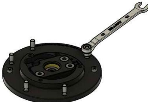
Maintenant, les goujons peuvent être montés avec un couple de serrage de 4 Nm par le haut, comme sur l'illustration ci-contre, aux positions déterminées auparavant.
