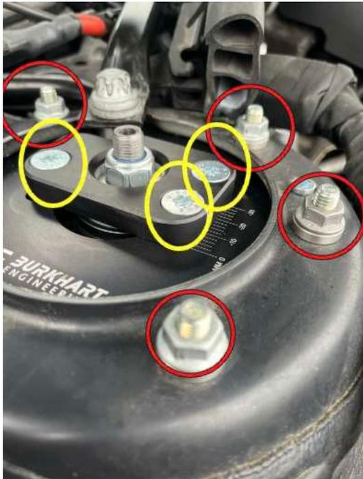
9. Comme indiqué en rouge sur l'illustration ci-contre, il faut maintenant monter les rondelles d'écartement et les écrous. Le couple de serrage des écrous est de 24 Nm.
