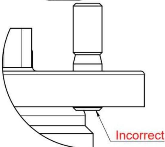
Le goujon ne doit pas dépasser sur la face inférieure de la plaque support, sinon un appui correct du roulement à billes à gorge profonde n'est pas garanti.
