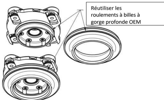
7. Tous les composants de la jambe de suspension (amortisseur, ressort, cache-poussière, butée, support de ressort, palier de dôme réglable, y compris le roulement à billes rainuré et l'écrou de blocage) peuvent maintenant être remontés. Le couple de serrage de l'écrou de blocage d'origine de la tige de piston est indiqué dans les instructions du constructeur automobile.
