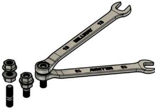
Visser deux écrous l'un contre l'autre sur le côté fileté le plus long de l'axe vertical de manière à ce qu'ils ne tournent plus. Si les écrous tournent encore à l'étape suivante, appliquer un peu plus de force.
