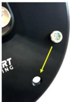
In caso di installazione su veicoli MINI, potrebbe essere necessario riposizionare i due perni di guida. A tal fine, regolare individualmente con il veicolo.
