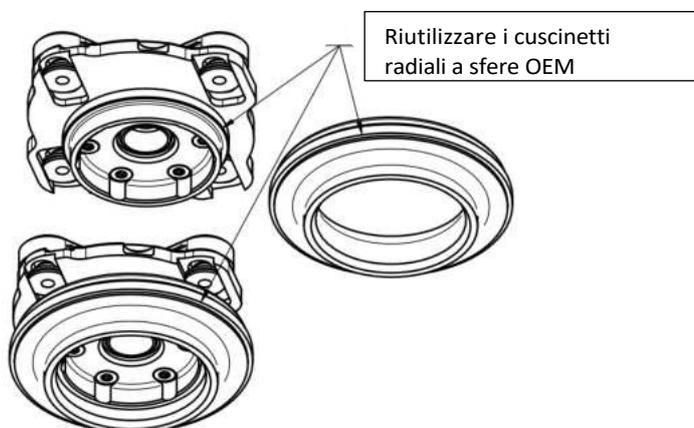
7. Tutti i componenti del puntone della sospensione (ammortizzatore, molla, parapolvere, paracolpi, cuscinetto della molla, cuscinetto regolabile del puntone, incluso il cuscinetto a sfera scanalato e il dado di bloccaggio) possono essere rimontati. La coppia di serraggio del dado di bloccaggio dell'asta del pistone originale è riportata nelle specifiche del produttore del veicolo.
