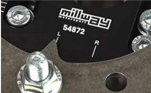
4. Die verstellbaren Domlager sind nicht für beide Seiten baugleich und müssen deshalb der richtigen Fahrzeugseite zugeordnet werden. Das Domlager in nebenstehender Abbildung muss entsprechend auf der linken Seite in Fahrtrichtung montiert werden.
