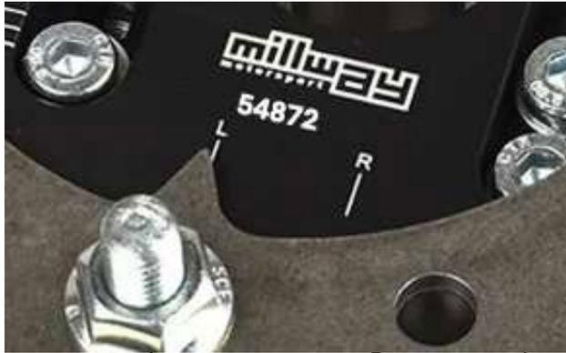
4. Les paliers de suspension réglables ne sont pas identiques des deux côtés et doivent donc être attribués au bon côté du véhicule. Le palier de butée illustré ci-contre doit donc être monté du côté gauche, dans le sens de la marche.
