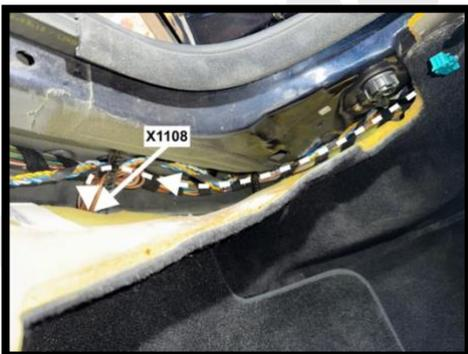
12. Grau / rote und grau / braune Leitung entlang am Kabelbaum über Lenkspindel Richtung Sicherungskasten verlegen
