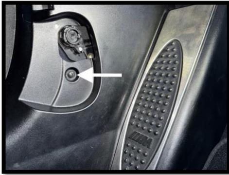
8. Blende Heckklappentaster entfernen und Heckklappentaster in Aussparung der Fußstütze verbauen
