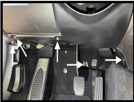
7. Fußstütze demontieren
