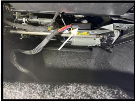
Hinweis: Nur bei abgeklemmter Batterie abstecken sonst folgt ein Airbagfehler
