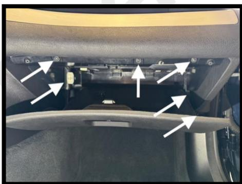
15. Beifahrerfußraumverkleidung entfernen
