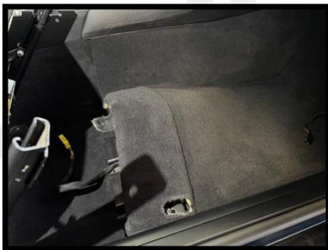
22. Kammverbinder X1019 lösen dieser ist nur auf den Stehbolzen gedrückt
