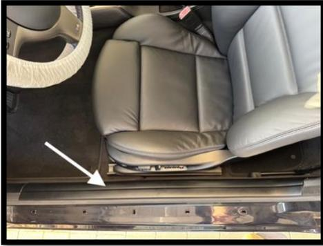
6. Fahrerfußraumverkleidung demontieren
