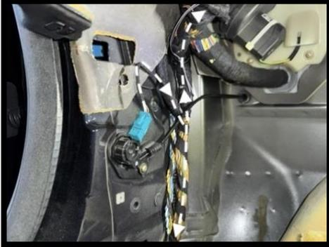
10. Kammverbinder X1108 bei Einstiegleiste Fahrerseite lösen, 10mm Sechskantmutter von Stehbolzen lösen
