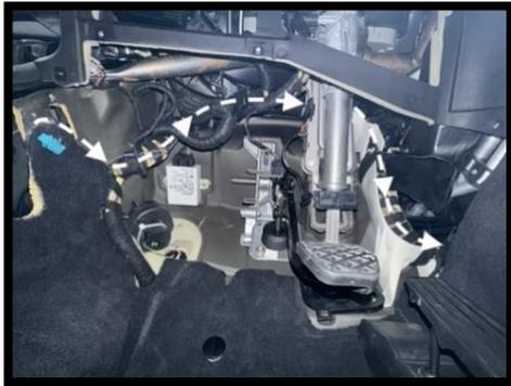
13. Zwischen Spritzwand und Gebläsekasten verläuft serienmäßig der Hauptkabelbaum hier ist ab Werk ein schwarzes Wellleerrohr verbaut
