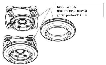
6. Tous les composants de la jambe de suspension (amortisseur, ressort, cache-poussière, butée, support de ressort, palier de dôme réglable y compris roulement à billes rainuré, bague d'adaptation (orientation comme sur l'illustration ci-dessous) et écrou de blocage peuvent maintenant être remontés. Le couple de serrage de l'écrou de sécurité d'origine est indiqué dans les instructions du constructeur automobile.
