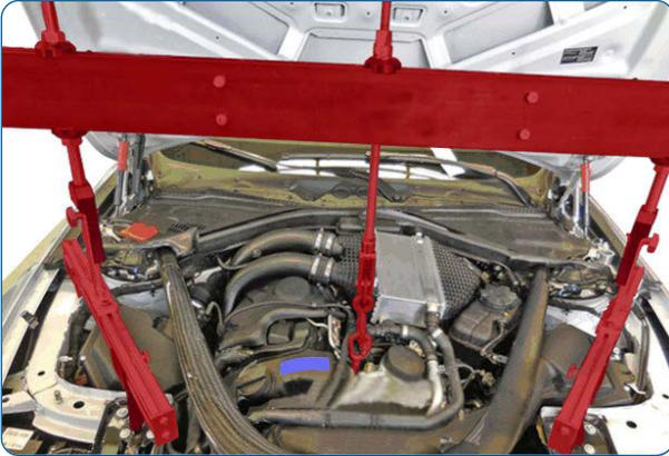
5.3.2 Motorlager links und rechts von unten lösen.
