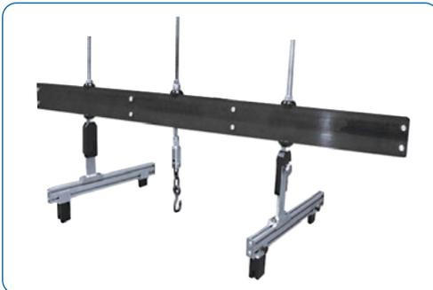
\*(Wir empfehlen die Verwendung einer originalen BMW Motorbrücke für das Fahrzeugmodell.)
