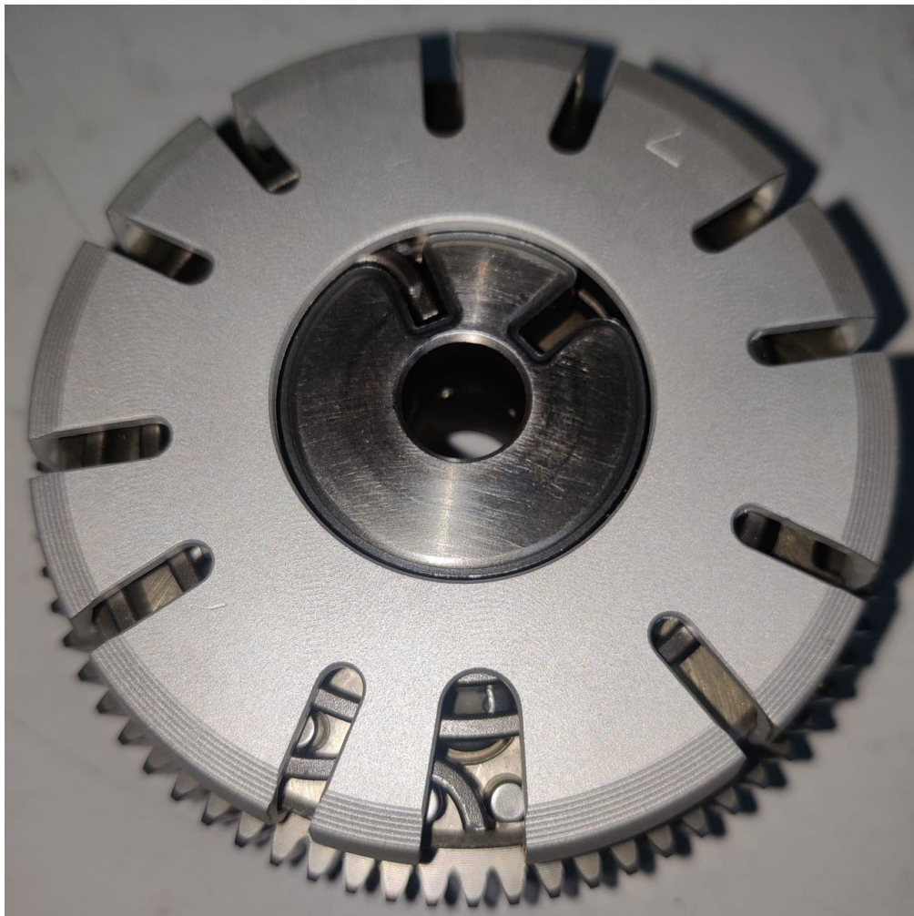
Abbildung 1: Darauf achten, dass der Deckel gerade und ohne zu verkanten von oben aufgesteckt wird, sodass alle „Flügel“ einrasten. Die Positionierung in Drehrichtung wie auf den folgenden Bildern beachten.
