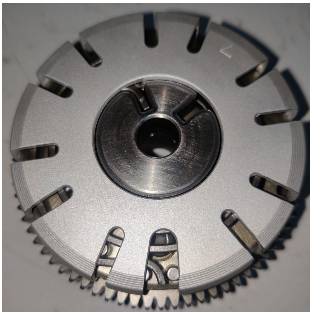
Figure 1 : Veiller à ce que le couvercle soit enfiché par le haut, bien droit et sans se coincer, de sorte que toutes les "ailes" s'enclenchent. Respecter le positionnement dans le sens de rotation comme sur les illustrations suivantes.
