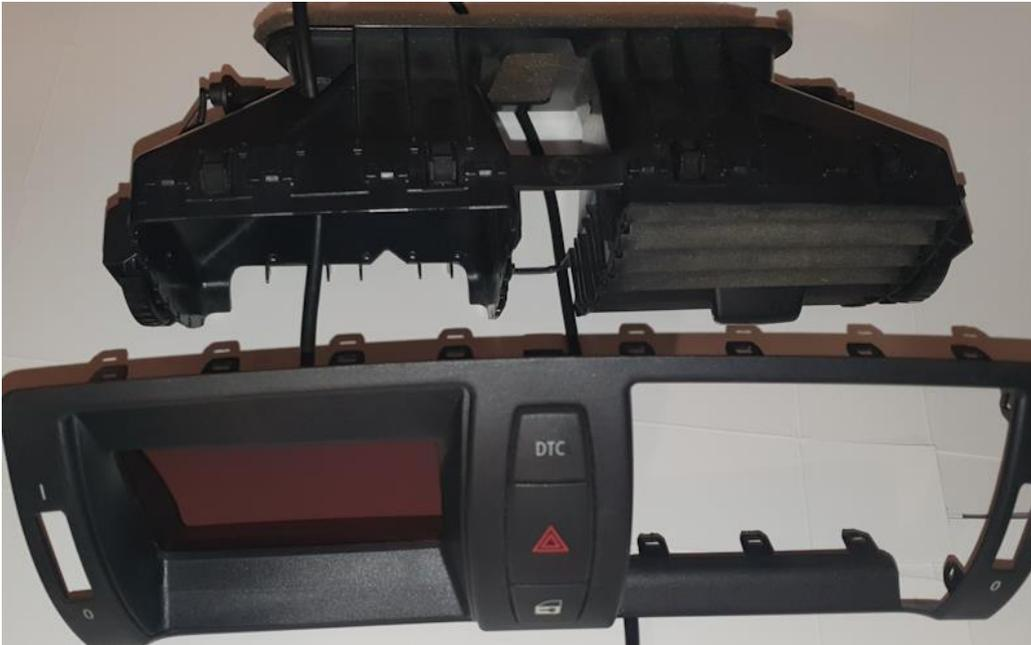
Die Blende mit Display zuerst unten ansetzen denn die Blende muss von unten nach oben in den Frischluftgrill gekippt werden.
