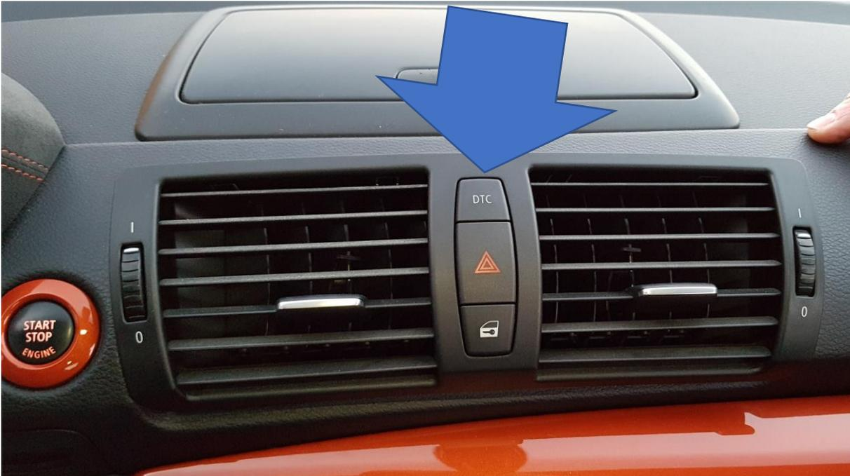
Wenn die Frischlufteinheit oben heraus gehobelt wurde, leicht nach vorne und nach oben ziehen. Als nächste muss der Stecker für die Schaltereinheit abgezogen werden:
