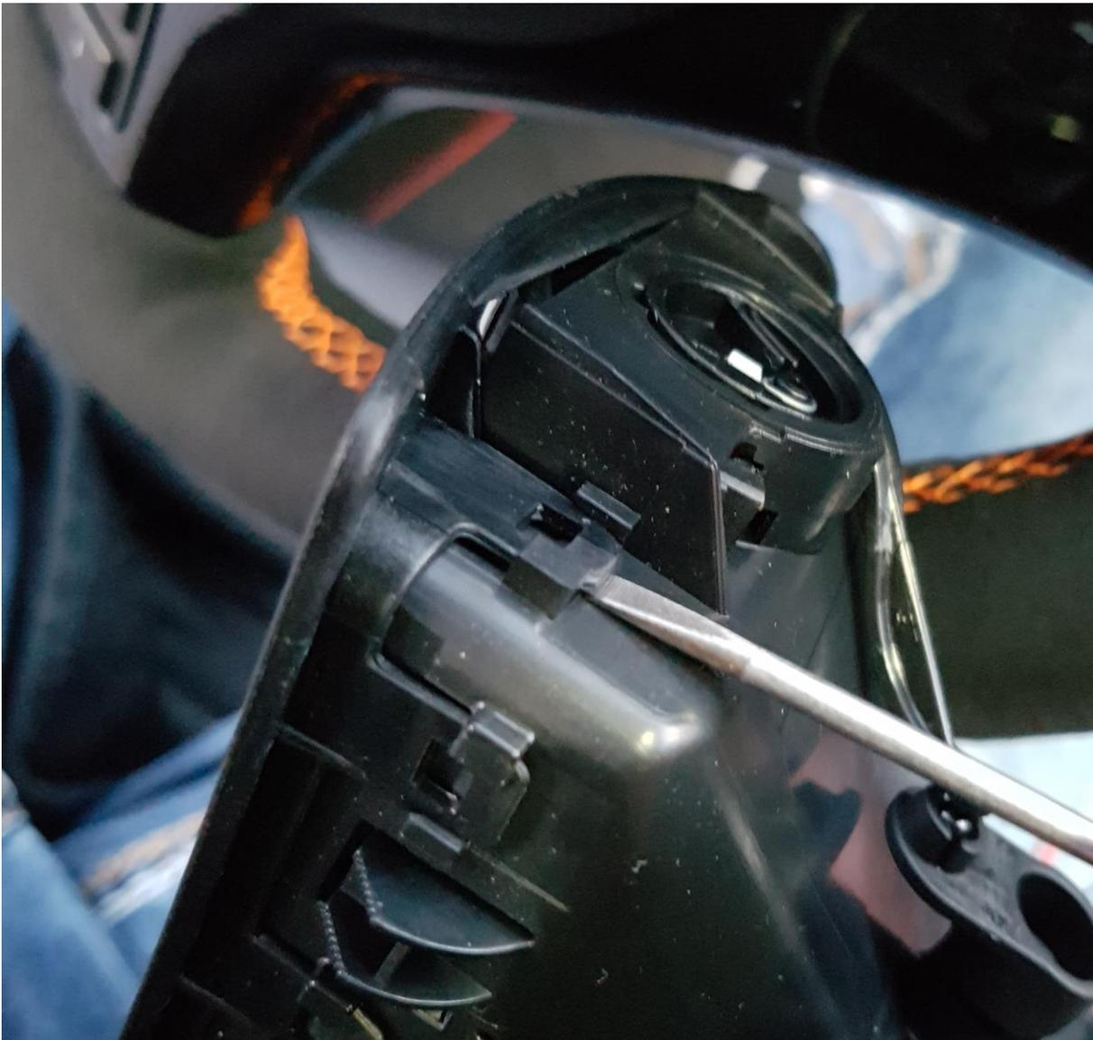
Den äußeren Rahmen Dann vorsichtig zuerst oben nach vorne ziehen und nach unten herunter klappen. Die Blende ist unter die Streben im Frischluftgrill geschoben.
