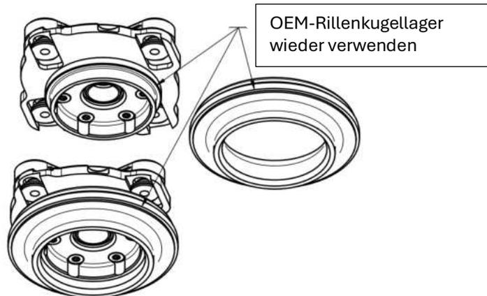
5. Alle Komponenten des Federbeins (Stoßdämpfer, Feder, Staubschutz, Anschlagpuffer, Federunterlage, verstellbare Domlager inkl. Rillenkugellager und Sicherungsmutter können nun wieder montiert werden. Das Anzugsmoment der originalen Sicherungsmutter ist den Vorgaben des Fahrzeugherstellers zu entnehmen.
