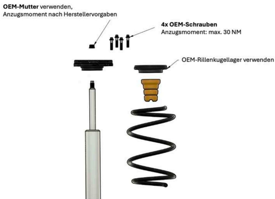
6. Der rote Aufkleber (falls vorhanden) kann nun vom Domlager entfernt werden: Dieser dient lediglich als Erinnerung an das maximale Anzugsmoment (30 Nm) für die Verschraubung des Domlagers an der Karosserie
