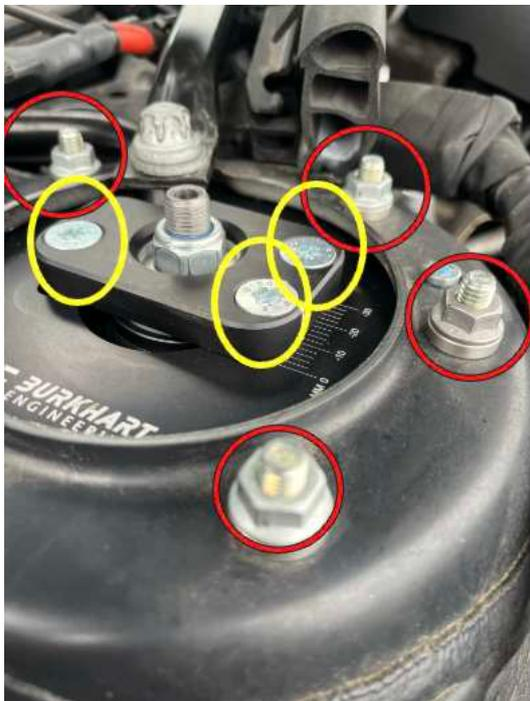
9. Wie in nebenstehender Abbildung rot markiert, müssen nun die Distanzscheiben und die Muttern montiert werden. Das Anzugsmoment der Muttern liegt bei 24 Nm.
