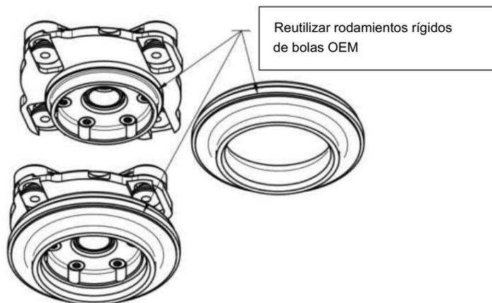
7. Ahora se pueden volver a montar todos los componentes del amortiguador. Incluido
