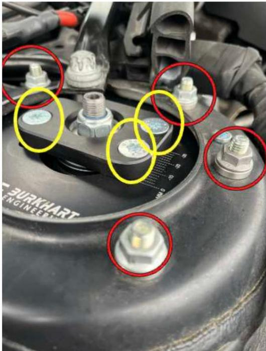
9. Como se marca en rojo en la siguiente ilustración, ahora se deben instalar las arandelas espaciadoras y las tuercas. El
