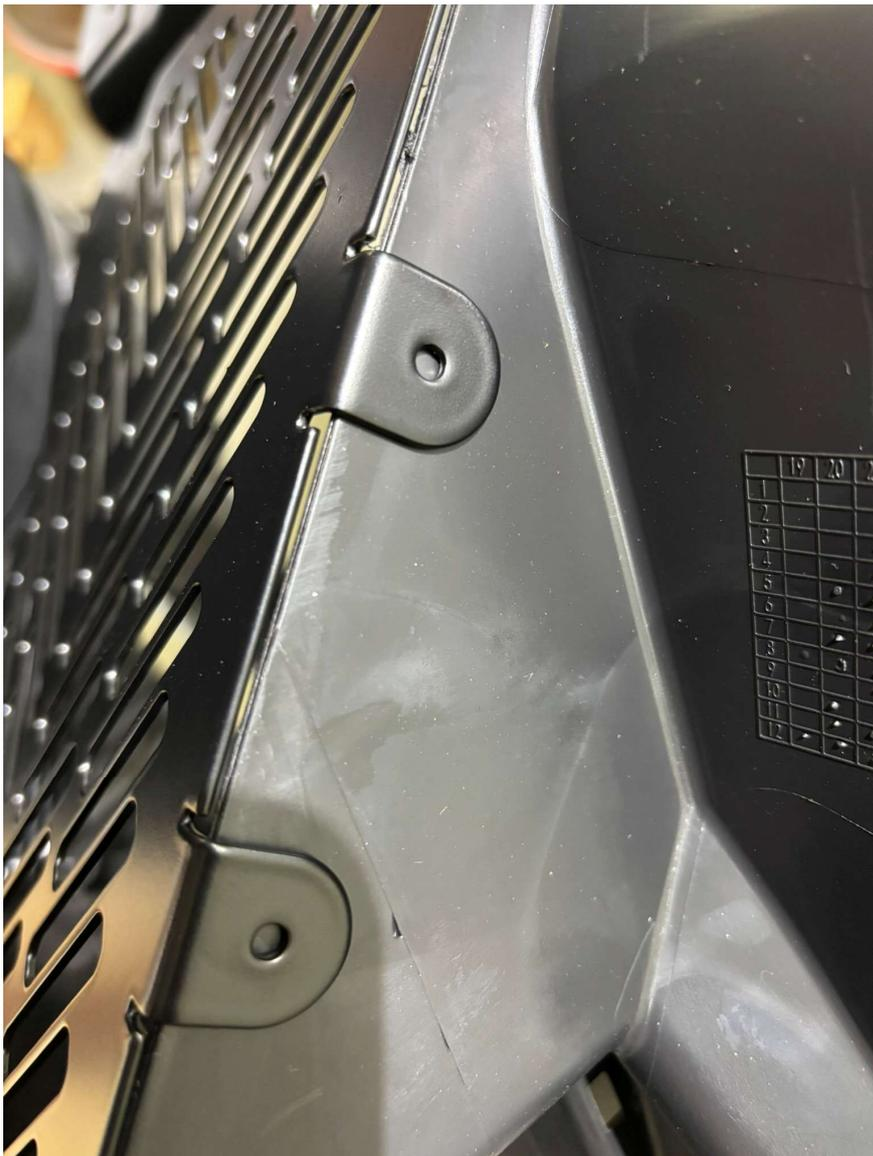
Darauf achten, dass alle Laschen in der richtigen Position sind. Halten Sie das Gitter mit leichtem Druck in Position.
