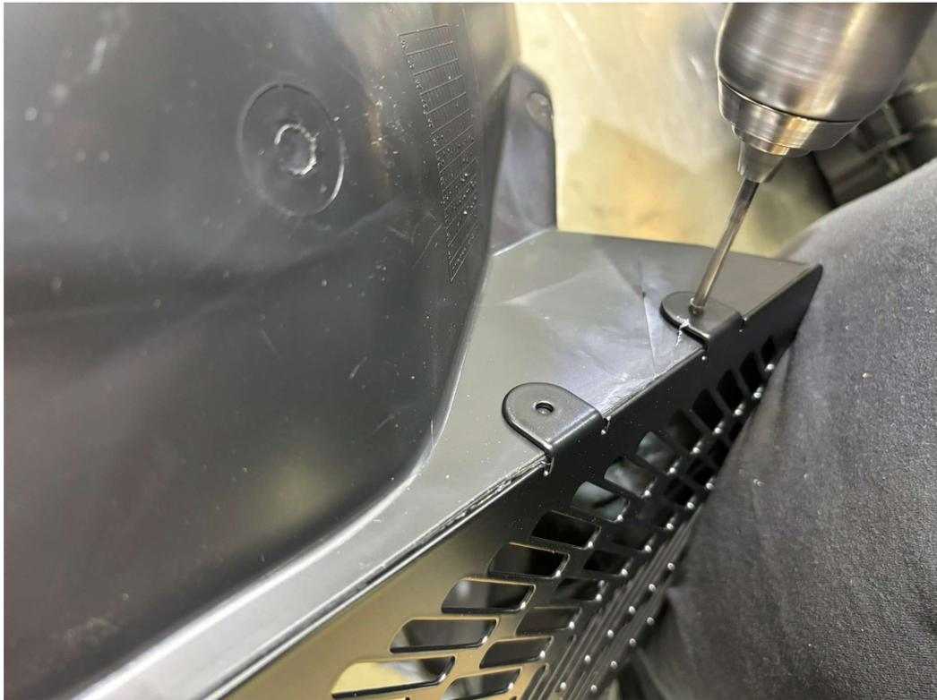
Bohren Sie mit dem 4mm Bohrer die Löcher der oberen zwei Laschen. Halten Sie dabei das Gitter in Position.
