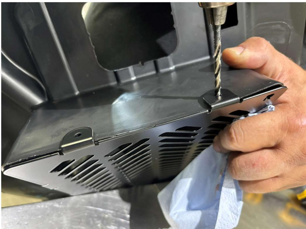
Bohren Sie jetzt vorsichtig die Löcher der zwei letzten Laschen. **ACHTUNG!** Hier besteht die Gefahr durch das Gitter zu bohren.
