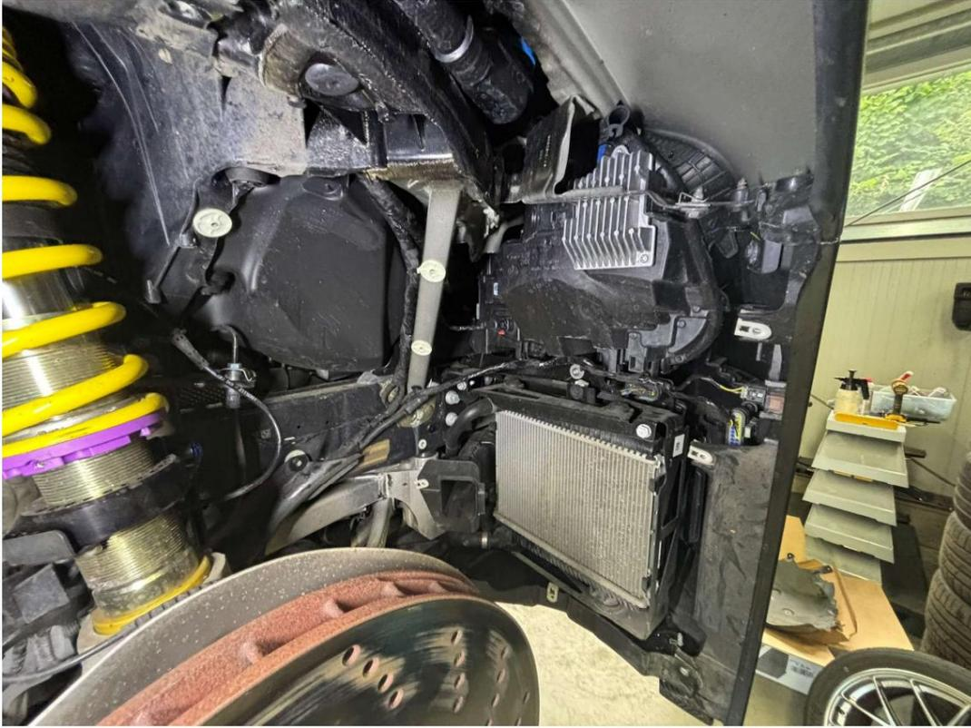
Retire con cuidado el revestimiento del paso de rueda delantero, asegurándose de que las tuercas de plástico no se desplacen ni dañen.
