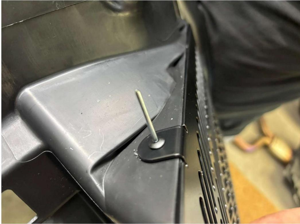
Después de perforar el orificio en cada pestaña superior, se debe colocar el remache como se muestra.
