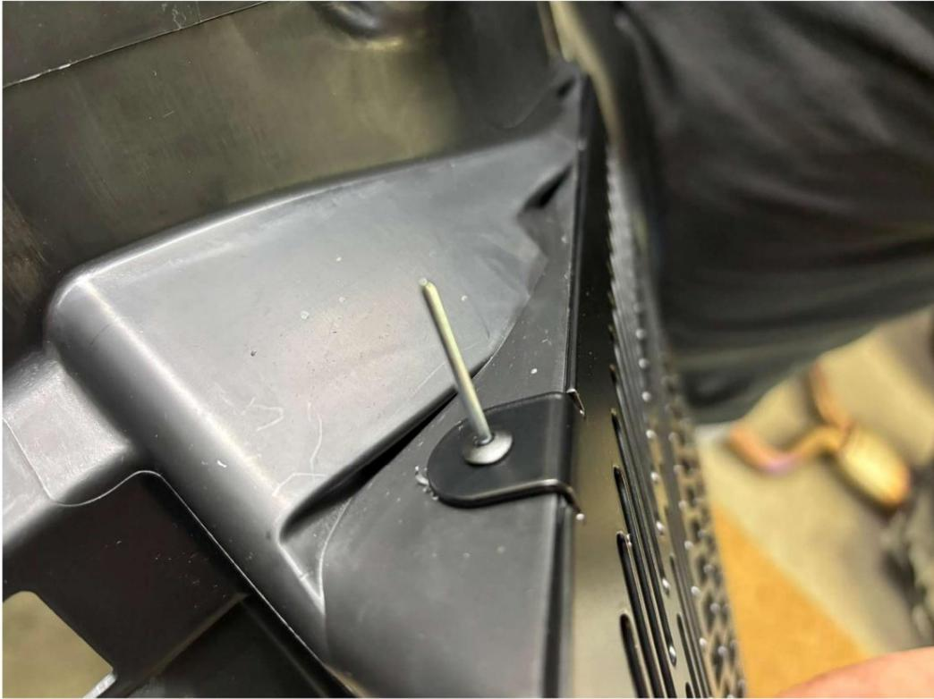
Después de perforar el orificio para la pestaña superior individual, se debe remachar el remache como se muestra.
