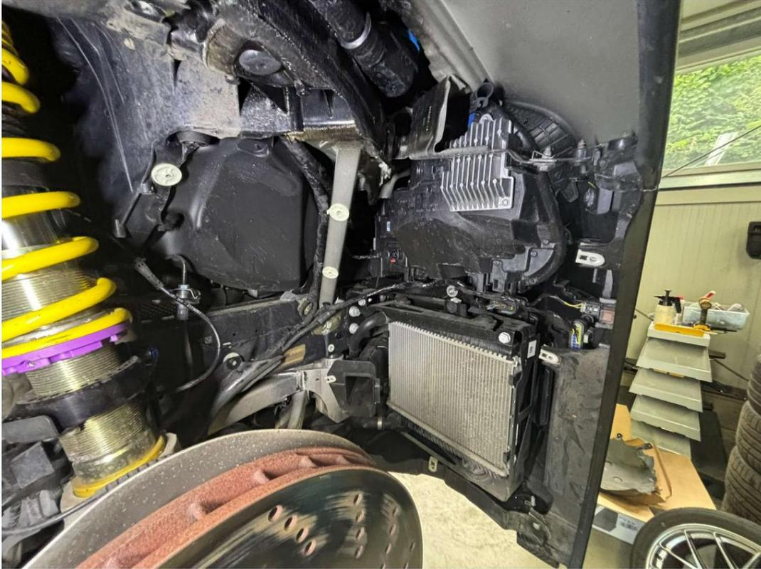
Rimuovere con cautela il rivestimento del passaruota anteriore, assicurandosi che i dadi di plastica non siano spostati o danneggiati.
