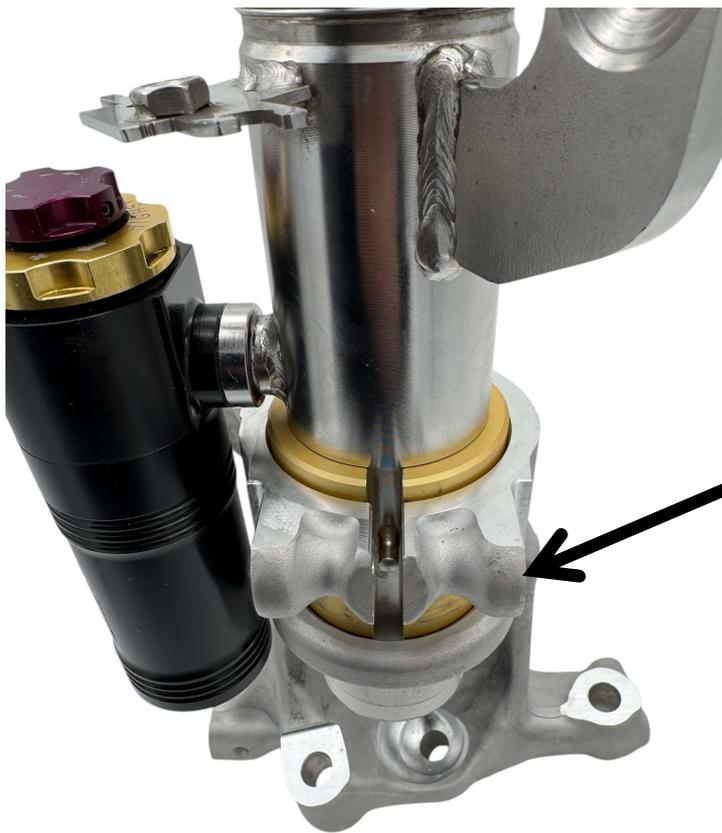
Entfernen Sie die Schraube an der Rückseite des Achsschenkels. Anschließend entfernen Sie den Halter für die Bremsleitung.
