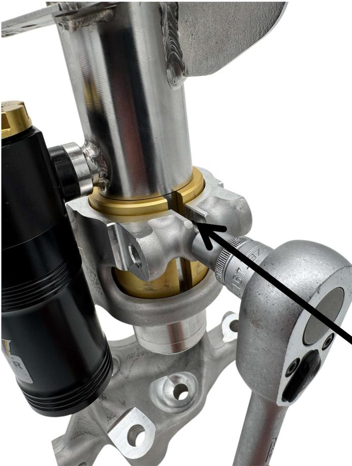
Spreizen Sie den Achsschenkel mit einem geeigneten Werkzeug. Der Achsschenkel lässt sich nun mit geringem Aufwand nach unten drücken.
