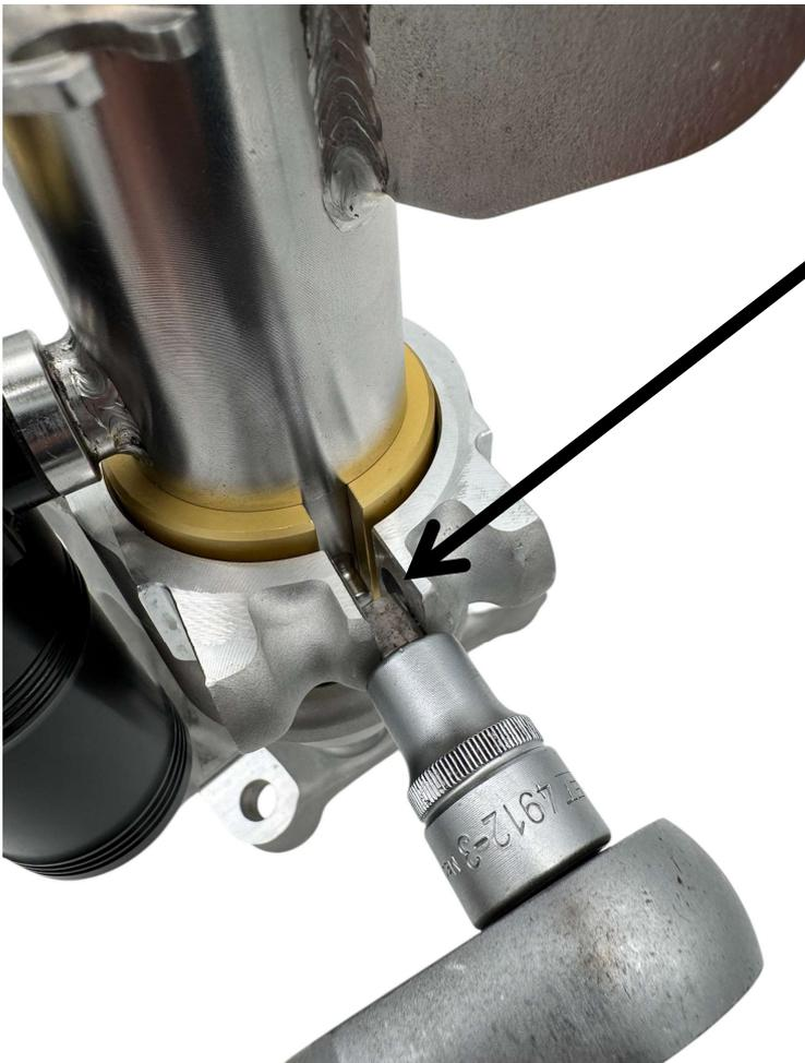
Schieben Sie den Achsschenkel vorsichtig so weit nach unten, bis das Federbein komplett entfernt ist. Achten Sie hierbei darauf, dass die Bremsleitung, sowie das Kabel vom Raddrehzahlsensor und der Bremsverschleißanzeige nicht beschädigt werden. Entfernen Sie anschließend die originale Hülse vom Federbein.
