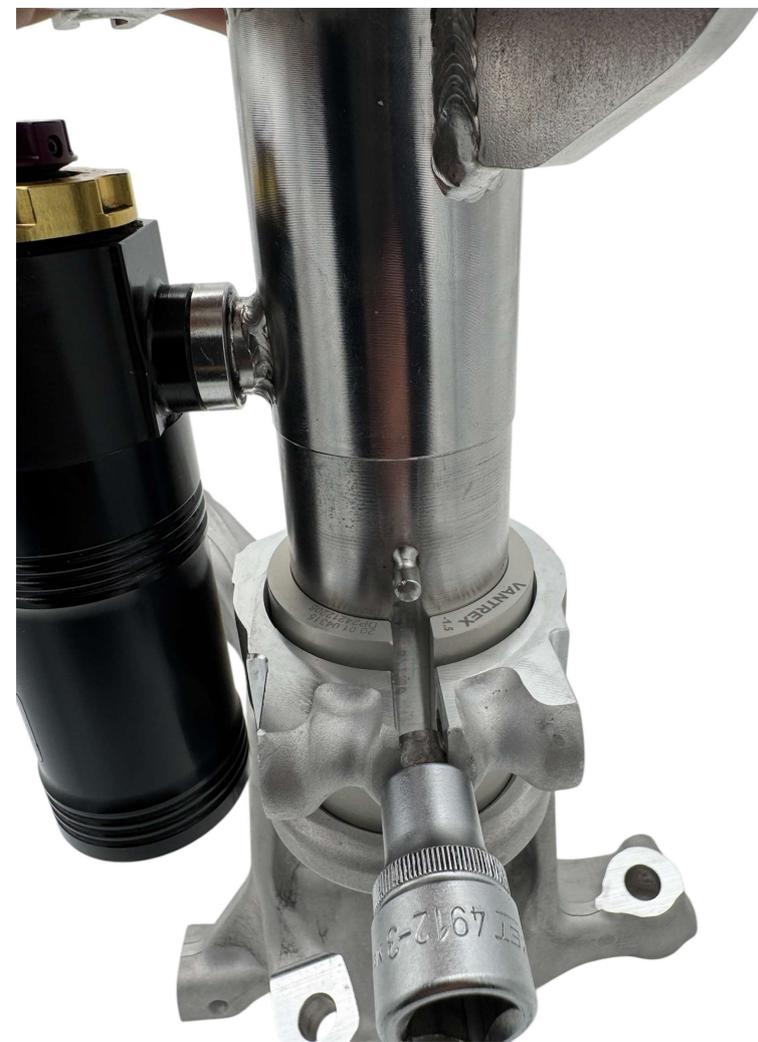
Schieben Sie den Achsschenkel von unten wieder über das Federbein. Achten Sie darauf, dass der Führungsstift am Federbein exakt mittig von der Bohrung sitzt.
