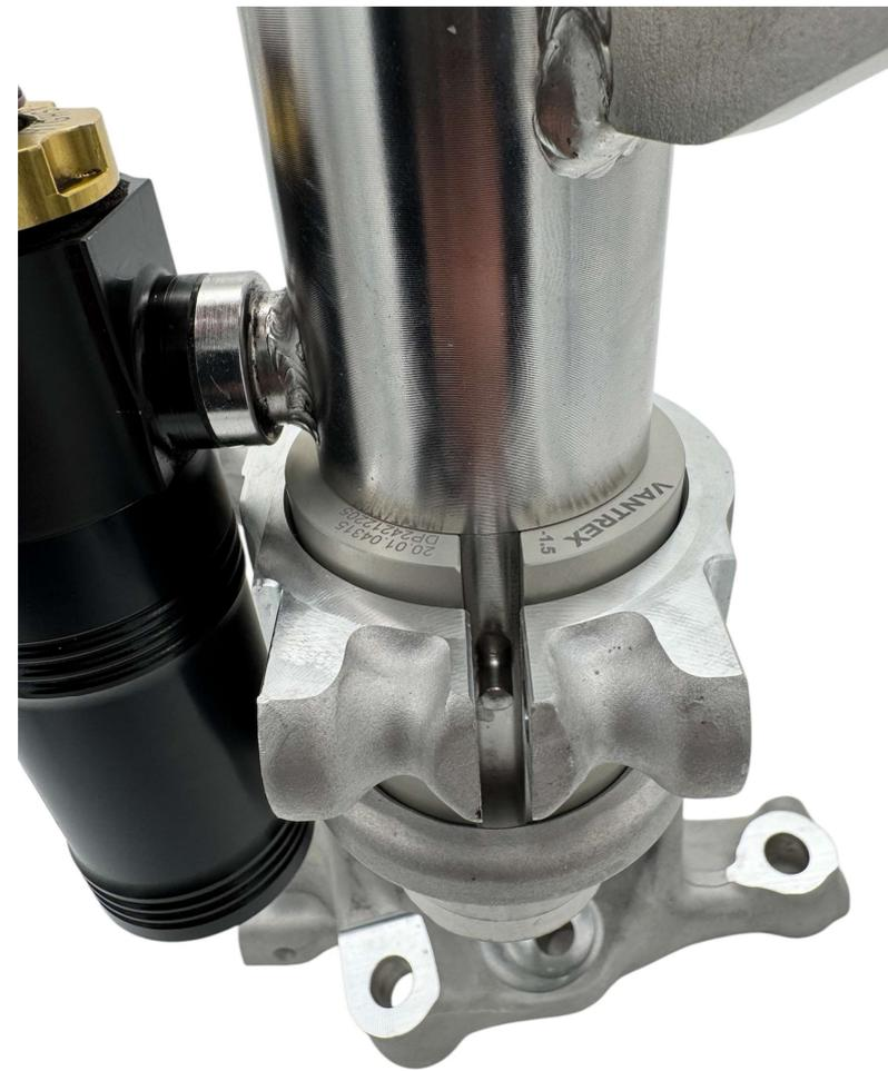
**Wichtig!** Entfernen Sie den Achsschenkel-Spreizer nur wenn sichergestellt ist, dass der Achsschenkel im Anschlag sitzt. Überprüfen Sie noch einmal den Sitz von Hülse und Führungsstift.
