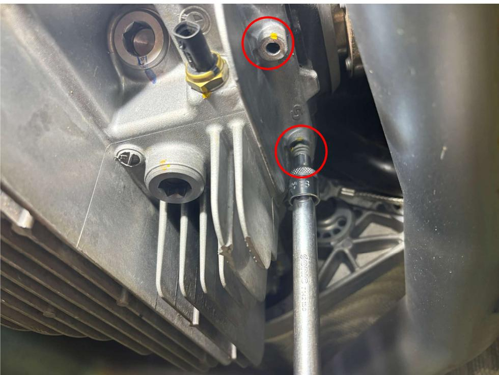
Entfernen Sie jeweils links und rechts die zwei Schrauben der Ölwanne vom Differential.
