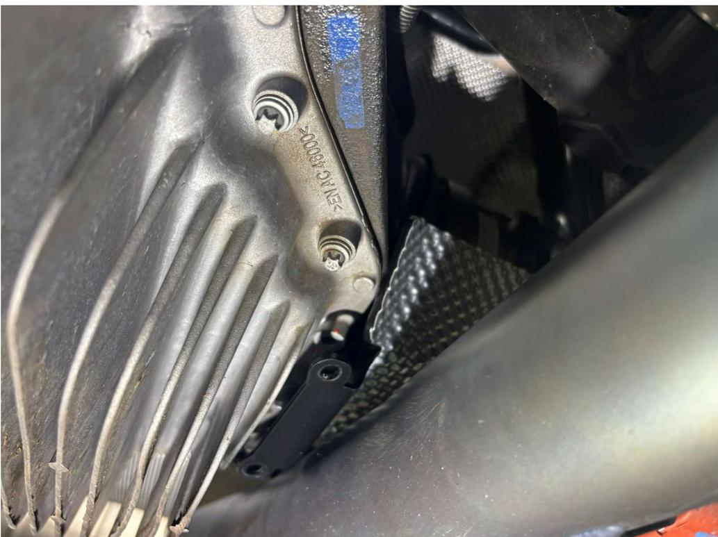
Verschrauben Sie nun das Hitzeschutzblech mit den beigelegten Schrauben zusammen mit jeweils einer Unterlegscheibe und ziehen Sie die Schrauben mit 12Nm fest.
